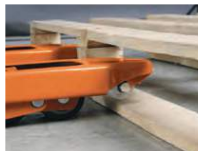
Rullo frontale che consente l'invito su pallet dotati di traversa inferiore
