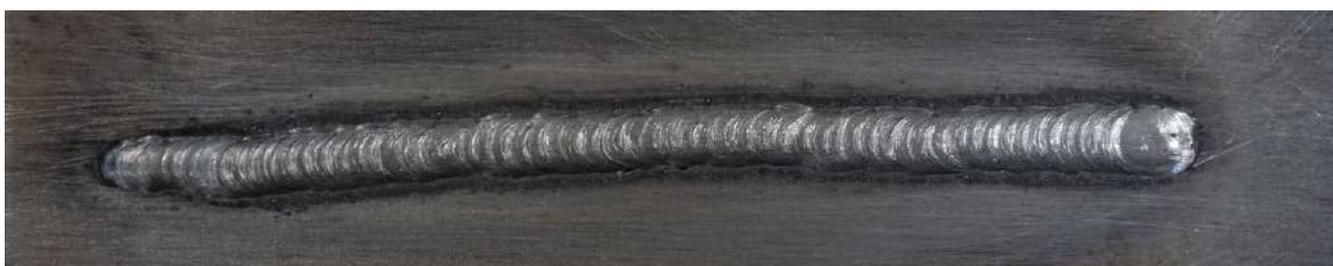
Saldatura con programma Elettrodo Pulsato su Ferro da 3mm con Elettrodo Rutile 6013 di diametro 2,5mm.
