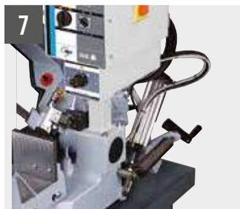
SHARK 281 - KIT CCS Cut Control System (dispositivo per taglio senza operatore)
