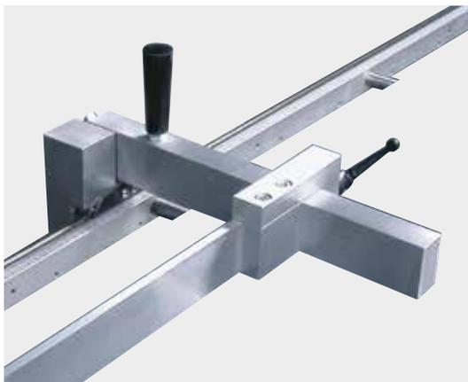
R1 BATTUTA RIBALTABILE (modello piccolo) per pianale di scarico tipo KK 200 e KK 330.
